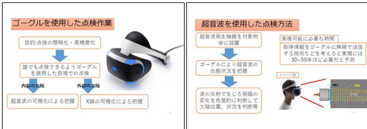
図 4.4.6 未来の点検技術・ゴーグルの活用
